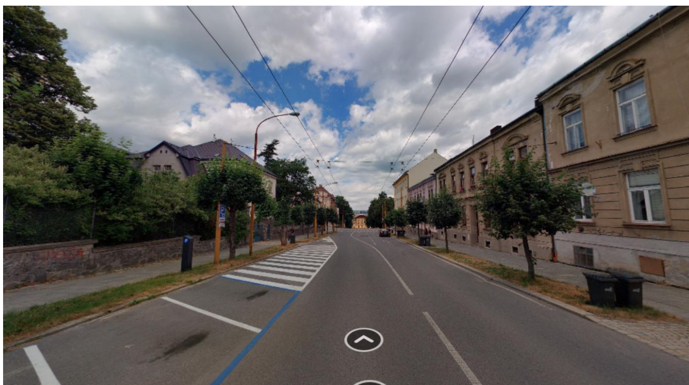
Spodní část řešeného úseku. Chodník vpravo (z pohledu fotografie) bude obnoven v celé šíři, VHI bude uložena v cca 2 m širokém pruhu podél chodníku ve vozovce.
